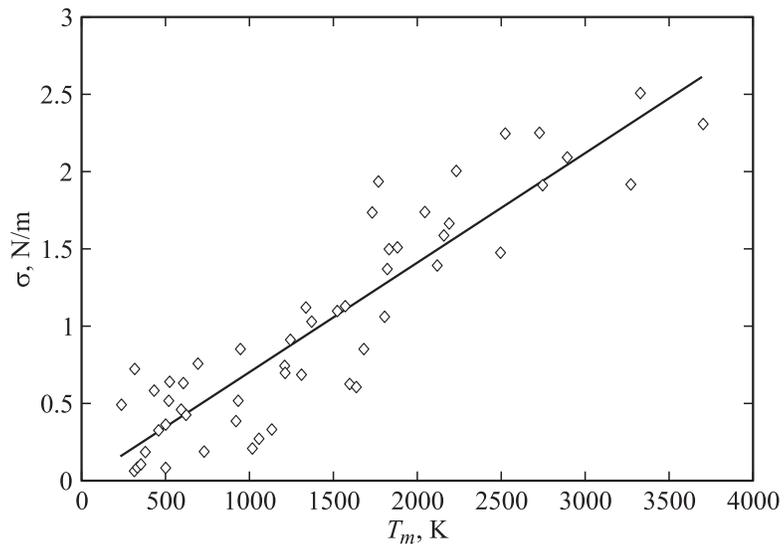
**Рис. 1.** Коррелятивная зависимость поверхностного натяжения от температуры плавления.
