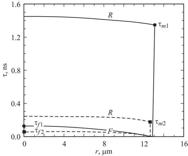
**Рис. 1.** Траектории движения фронта ( $F$ ) и тыльной поверхности ( $R$ ) волны плавления в координатах радиус–время для режимов 1 (сплошные линии) и 2 (штриховые). Время отсчитывается от момента начала плавления на поверхности проволоочки,  $\tau = t - t_{m0}$ . Значками отмечены моменты начала плавления на оси симметрии ( $\tau_f$ ) и окончания плавления на поверхности ( $\tau_m$ ).
