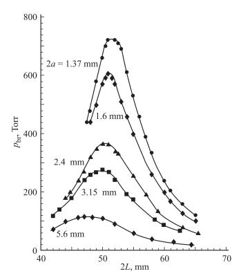
**Рис. 5.** Результаты экспериментов при помещении электромагнитного вибратора над экраном в пучность поля.
