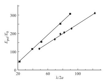
**Рис. 4.** Зависимость отношения поля на вершине-полюсе вибратора резонансной длины к исходному полю от диаметра вибратора.
