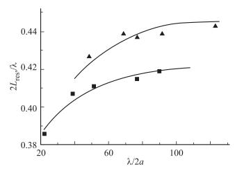
**Рис. 3.** Резонансная длина "полуволнового" вибратора в зависимости от его диаметра.
